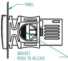
**XR60CX** 温控器应该固定在竖直的面板上, 面板上开孔尺寸 29x71 mm, 并用专用的塑料卡片将其固定。工作环境需在 0-60 °C 范围内才能保证它的正常运行, 应避免放置在有较强震动、有腐蚀性气体、脏乱不堪及潮湿的地方。探头的安装也有同样的要求。让空气能够从温控器的散热孔流通起来, 以便带走热量。
